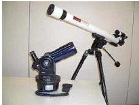
左：屈折電子制御フォーカス式天体望遠鏡 右：屈折式天体望遠鏡
